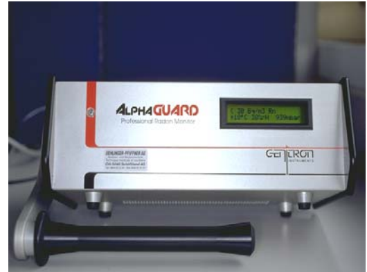
Alphaguard-Messgerät zur Aufzeichnung von Radon-Ganglinien
