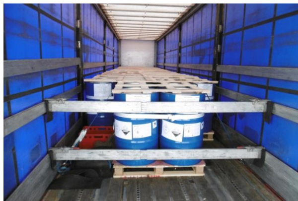
Wie es sein sollte: eine perfekte Sicherung der Gefahrgutladung!
