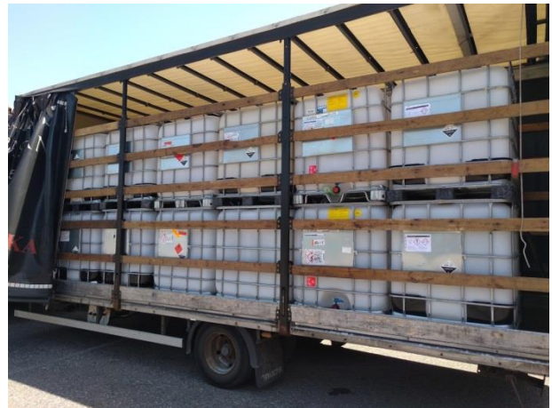
Das Gefahrgutrecht ist auch bei der Beförderung von leeren, ungereinigten Gebinden zu beachten, da von deren Restmengen noch Gefahren ausgehen.
