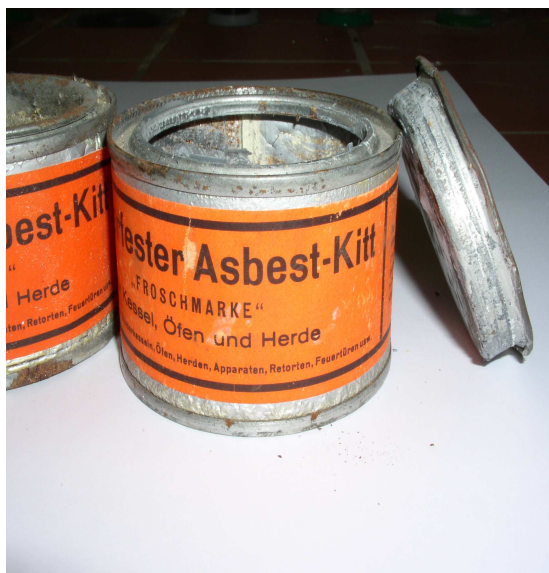
Feuerfester Asbest-Kitt gefunden in einer Privatliegenschaft
