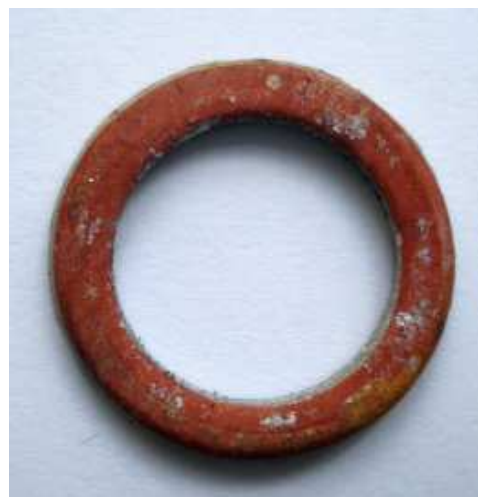
Asbesthaltiges Dichtungsring einer Öllampe
