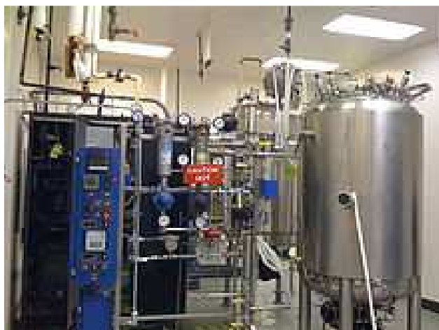
Bioreaktor für die Produktion von Vaccinen (Quelle: Wikipedia): Bei Bioreaktoren handelt es sich in der Regel um komplett geschlossene und gut überwachte Systeme, die strengen Kontrollen unterliegen.
