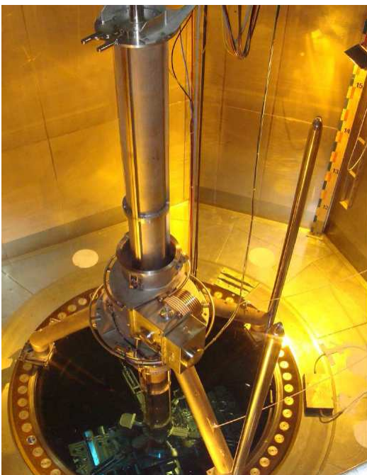
Abbildung: Roboter zur Inspektion des Reaktordruckbehälters (Quelle: EDF – Dossier de Presse 15.2.2010)
